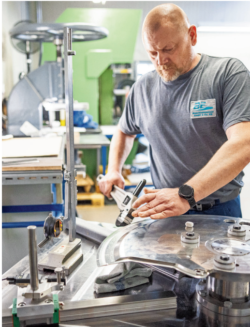
David Nickel beim Richten eines Maschinenmessers. Mit der Messuhr prüft er, dass die Toleranz von 0,2 Millimetern eingehalten wird.
